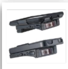
**KDC400** Lettore Barcode Bluetooth. Accoppiandosi con smartphones e tablets, cattura Barcode, MSR, NFC e RFID. La batteria può ricaricare il device associato via USB.
