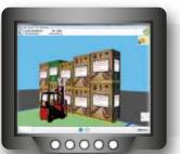
La visuale esterna assiste l'operatore durante le operazioni di prelievo e deposito dei pallets, illuminando con un colore specifico il pallet da prelevare. In fase di deposito suggerisce all'operatore la migliore posizione nella quale rilasciare il pallet.
