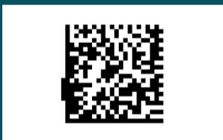
**Danneggiamento del pattern fisso:** analisi di errori o difformità eventualmente presenti nel Finder Pattern, nel Clocking Pattern e nella Zona di Quiet, rispetto al modello di sincronizzazione.
