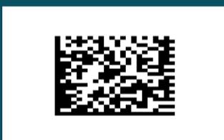
**Uniformità assiale:** misurazione dell'omogeneità di un eventuale ridimensionamento dell'aspetto del simbolo.
