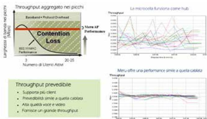
La controller di Fortinet-Meru, invece, avendo il controllo della situazione, ordinerà a tutti i client il momento esatto in cui possono trasmettere e quello in cui non farlo. Tutti quanti avranno un trattamento equo. Come si vede espresso dal
