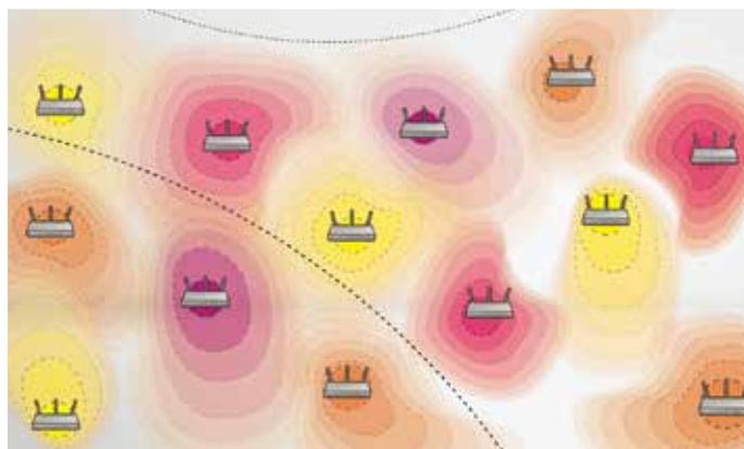
Grazie alla controller centralizzata di terza e quarta generazione, invece il tutto avviene in maniera automatica. Quindi, la prima cosa che fanno i sistemi di 3ª generazione, è distribuire i canali su frequenze diverse. La seconda cosa che fanno è la riduzione della potenza delle celle radio in caso di disturbo, in modo tale da allontanare virtual-
