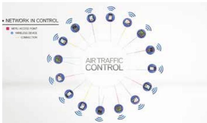
Terzo elemento: Virtual Port. Ogni client che si connette a una rete Fortinet-Meru, ha a disposizione un access point (AP) virtuale a lui dedicato, che viene generato da qualsiasi AP fisico in cui il client passerà. Ogni volta che gli AP fisici ricevono una richiesta di associazione di un client, producono un access point virtuale.
