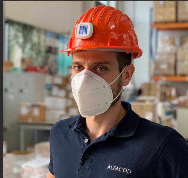
In un sistema di localizzazione in tempo reale il tag è un piccolo dispositivo auto-alimentato che viene associato a un oggetto, un veicolo o una persona che si desidera tracciare. Il tag invia impulsi continui che vengono ricevuti dalle ancore e inoltrati al server di localizzazione per il calcolo dell'esatta posizione del tag.
