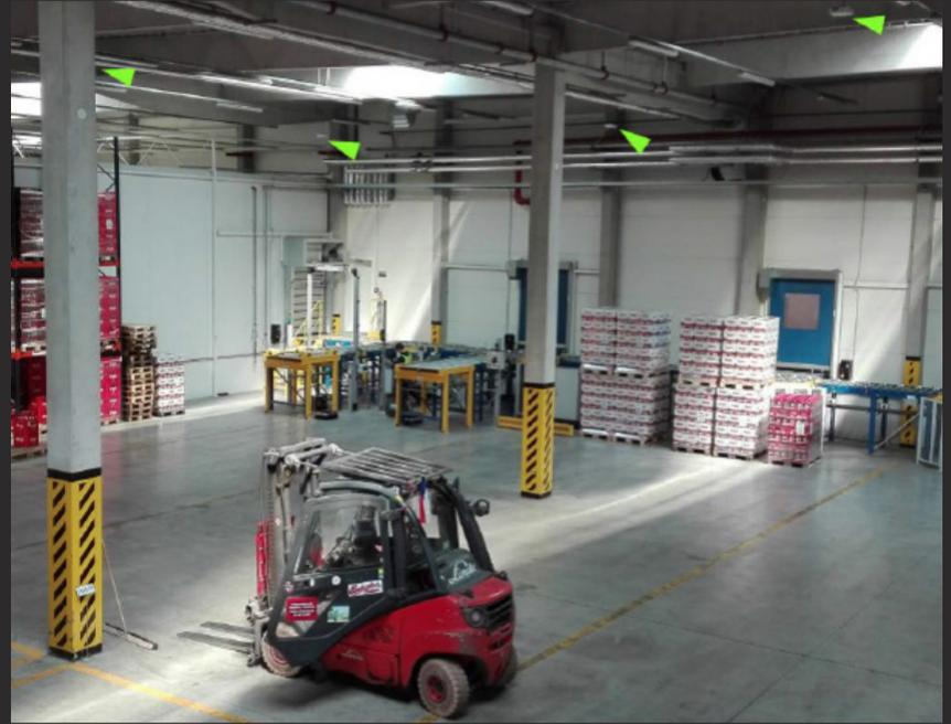
Per coprire i 15.000 mq complessivi sono state utilizzate 70 ancore. 15 muletti sono stati equipaggiati con tag Ultra-Wide Band alimentati direttamente dal terminale del veicolo, pertanto senza necessità di essere ricaricati. Il movimento è stato tracciato con una frequenza di 100 millisecondi e il sistema ora è in grado di tracciare in tempo reale più di 20.000 pallet di due tipologie diverse.
